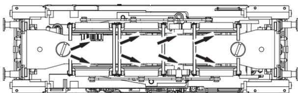
**Reinigen der Lokräder:** Bei Verschmutzung sind die Laufflächen der Räder mit sauberem Lappen oder Schienenreinigungsgummi 6595 zu reinigen. Niemals die angetriebenen Räder von Hand durchdrehen, sondern durch Anlegen einer Fahrspannung mittels Anschlussdrähten antreiben. Nichtangetriebene Räder können von Hand gedreht werden.
